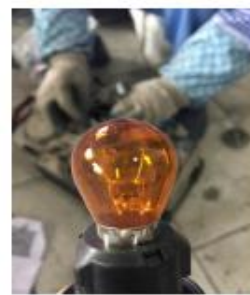
灯泡断丝应更换灯泡， 不能更换整灯
