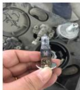
灯泡断丝应更换灯泡， 不能更换整灯
